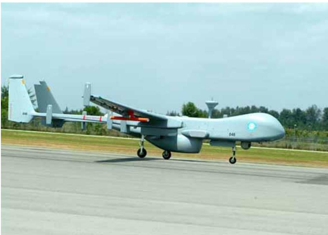
Figura 19: Veículo aéreo não tripulado Heron.
