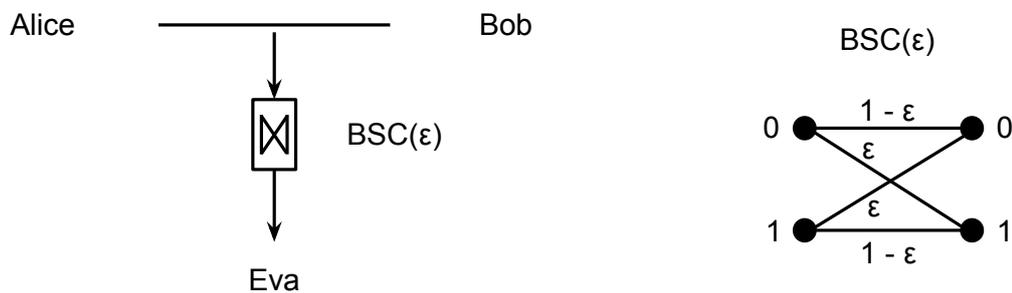
Figura 2.1: Canal Simétrico Binário simples. (Fonte: [31])
